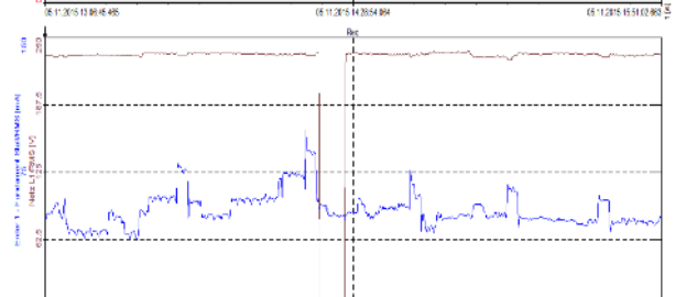
Kurzzeit-Darstellung über ca. 2 ½ Stunden Hofanlage wurde durch entfernen der Hauptsicherungen vom Versorgungsnetz getrennt! Verlauf Strom Erder 1 – Fundament Stall : Skala: 0 – 150 mA Verlauf Netzspannung Hofanlage L1/N : Skala: 0 – 250 V
