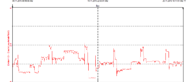
Kurzzeit-Darstellung über ca. 2 ½ Stunden Verlauf Strom Erder 13 – Dach Laufstall Skala: 0 – 5 mA
